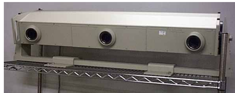
光学式3次元センサ (精度 0.1 mm)
