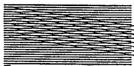
図 7.2 モアレ縞。二つのパターンの相互作用によるエイリアシングの一種。二つのパターンの周波数が近い場合信号と区別できない干渉縞が現われている。
